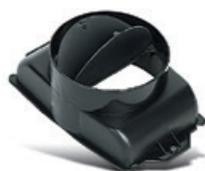
В режиме отвода воздуха антивозвратный клапан препятствует попаданию в квартиру неприятных запахов, находящихся в вентиляционных шахтах. Достигается это за счет створок клапана, которые открываются только при работе вытяжки, когда воздух из кухни выходит в шахту.
